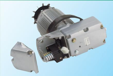
Directement accessible sur le système d'engrenage, le fin de course à 4 cames permet de contrôler les limites hautes et basses du crochet, le passage petite/grande vitesse et de gérer les inversions de phase.
