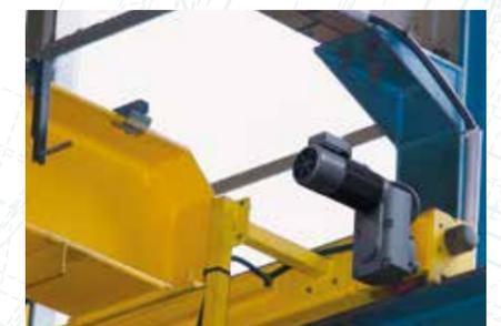
**Poutre taillée en biseau** afin d'utiliser au maximum la distance disponible sous les éléments de charpente et d'optimiser la hauteur de levage de vos charges.
